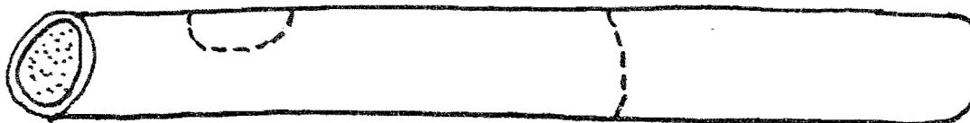
Von dem Holzkern wird ein etwa 1,5 cm langes Stück abgeschnitten und seitlich etwas abgeflacht, das wieder in die Röhre gesteckt wird. Dann wird die Röhre wieder auf das Kernholz geschoben. Mit dem beweglichen Kernholz kann die Tonhöhe verändert werden.
